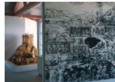
Reconstitution d'un bocard permettant de broyer le minerai à la Maison de Pays.
